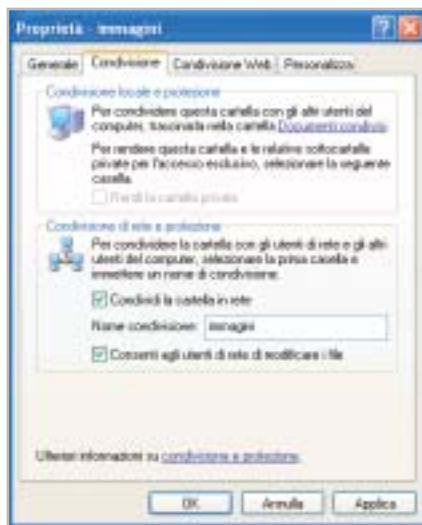
Windows XP Home Edition permette di condividere dati in rete, ma non di specificare i diritti d'accesso
