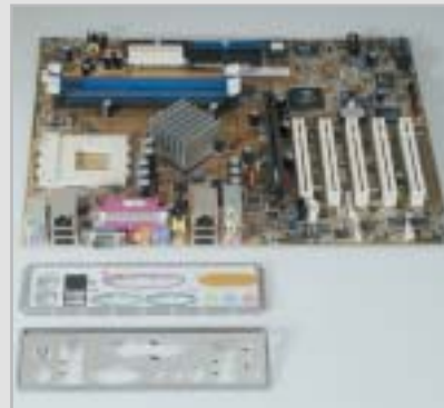
Sostituendo la maschera di copertura delle porte posteriori si adatta il case alla motherboard
