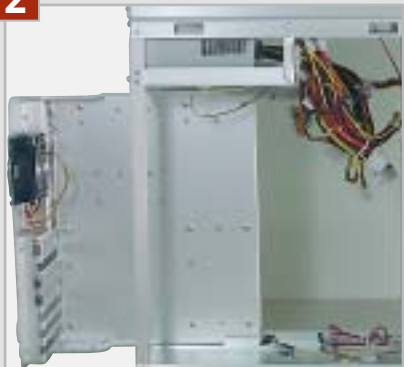
La piastra su cui andrà montata la mainboard può essere estratta dal case Cooler Master
