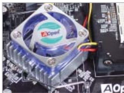
Ventola del north bridge colorata: anche AOpen segue i canoni del modding
