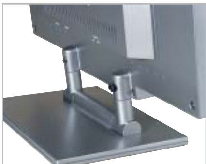
L'originale forma del supporto del monitor Olidata: due viti fissano lo schermo al basamento
