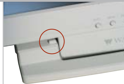
Il piccolo dente della cerniera del Waitec gli impedisce di assumere una posizione perfettamente verticale
