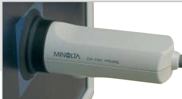
L'analizzatore colore Minolta CA-100 all'opera: oltre alla luminosità, questo strumento consente di determinare accuratamente la temperatura colore
