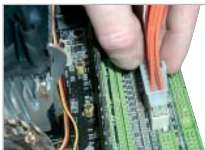
8 Alimentazione della scheda madre: ricordatevi di innestare anche il connettore supplementare per il P4
