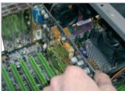
7 Accertatevi che il sistema di aggancio integrato sul pettine Agp blocchi correttamente la scheda video
