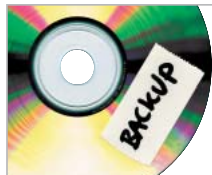
5 Applicando etichette adesive sui Cd-R economici, che non hanno vernice protettiva, si rischia la perdita di tutti i dati contenuti
