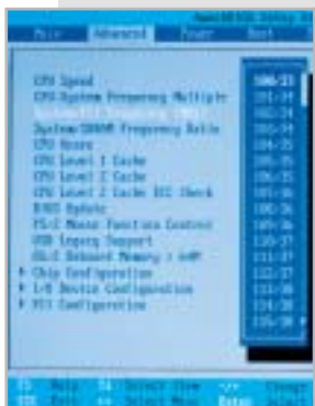
Molte motherboard permettono di impostare la frequenza dell'Fsb nel Bios; a volte è anche disponibile un apposito software per Windows
