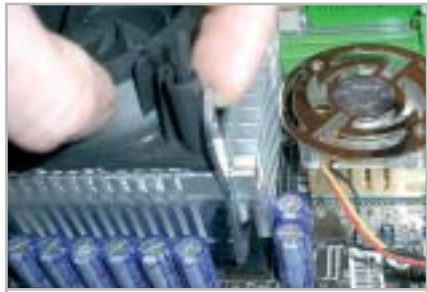
2 Il sistema di aggancio del dissipatore Verax richiede un preciso allineamento dei fermi metallici e una pressione decisa
