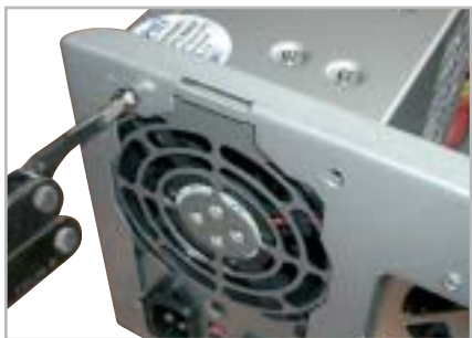
1 Il montaggio dell'alimentatore: fate attenzione a montarlo nel verso giusto, servendosi di quattro viti a stella
