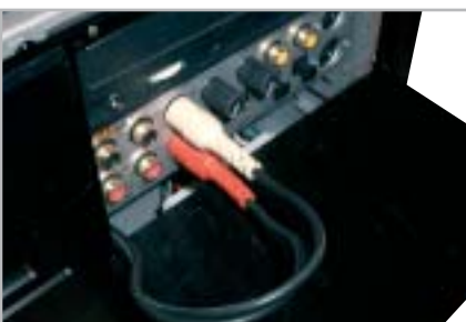
10a Uscite e ingressi audio possono essere riportati sul retro dell'HTPC per il collegamento con l'amplificatore
