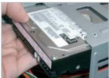
9 Meglio posizionare l'hard disk nel vano superiore: questa scelta facilita la circolazione e il ricambio d'aria
