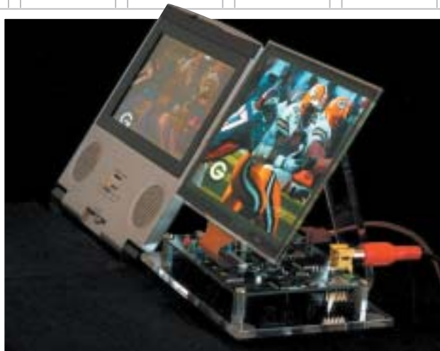
Il confronto diretto fra un display Lcd (a sinistra) e uno Oled (a destra), ben visibile da ogni angolo visuale e brillante, dimostra uno dei punti di forza della nuova tecnica
