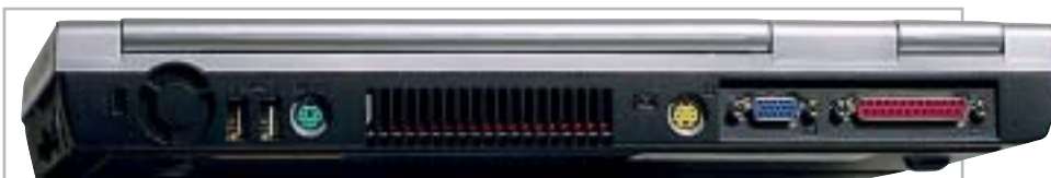
Il modello 35AS1 di Hyundai è uno dei pochi equipaggiato con una porta Ps/2
