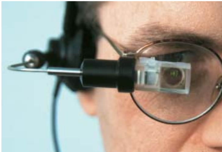
Il piccolo display Oled ad alta risoluzione, sviluppato da IBM a Zurigo, proietta direttamente un'immagine grande
