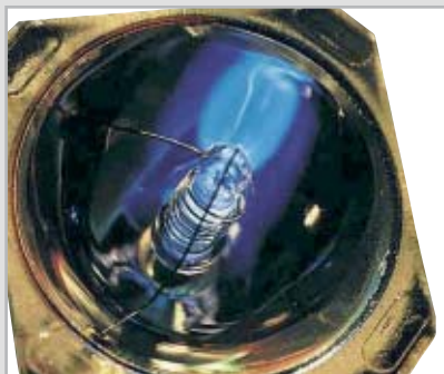
Una lampada da proiezione di tipo Uhp (Ultra High Pressure), comunemente impiegata nei videoproiettori
