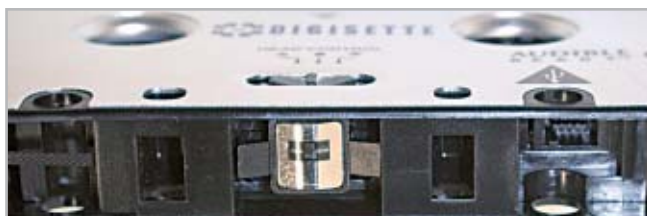
Il trasduttore magnetico del Digisetete Duo 96 consente di riprodurre i brani Mp3 con un normale registratore a cassette
