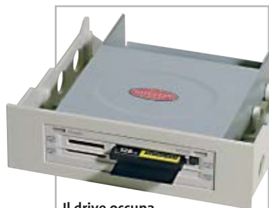
Il drive occupa lo spazio di un lettore floppy e legge sei tipi di schede di memoria
