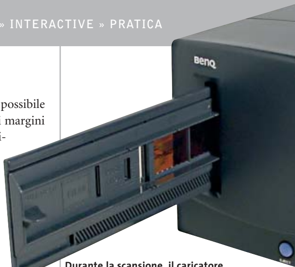
Durante la scansione, il caricatore arriva a sporgere fino a una trentina di centimetri dallo scanner
