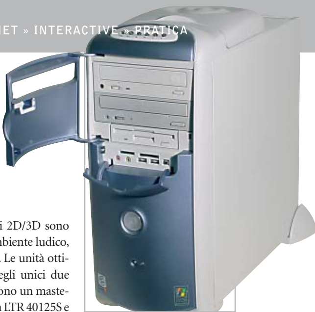
Connettori e drive, escluso il masterizzatore, sono protetti da due sportelli
