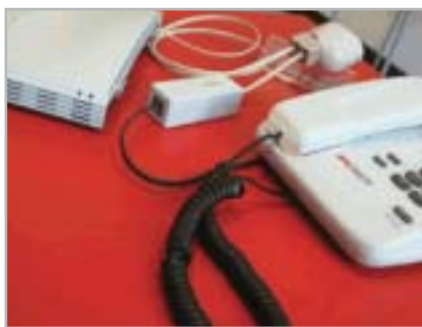
8 Il microfiltro Adsl può bloccare anche molti disturbi della normale linea telefonica
