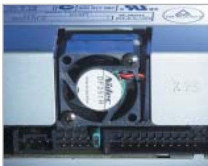
Il masterizzatore Dvd di Asus è l'unico a essere dotato di una ventola: gli altri ce la fanno anche senza dissipatore
