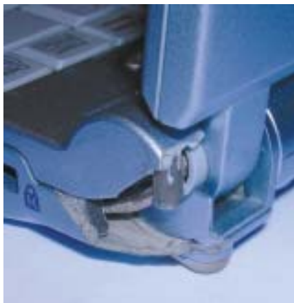
Pády a opotřebení jsou často důsledkem poškození – popraskání kloubů displeje
