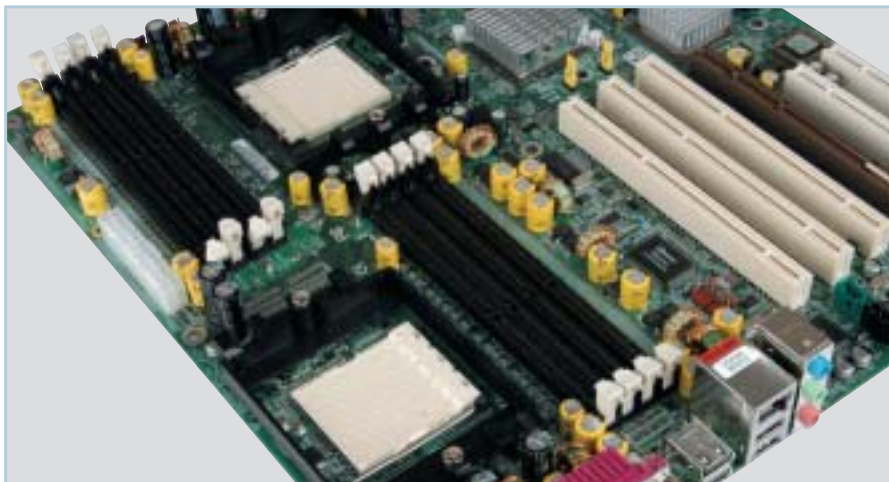
Řadiče operační paměti jsou v případě AMD Opteronu umístěny přímo uvnitř procesorů. Každý procesor může adresovat do 8 GB registrované paměti.
