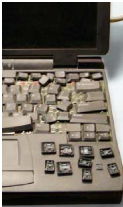
Klávesnice notebooku po pádu lehkého předmětu, který byl i tak schopen napáchat velké škody.
