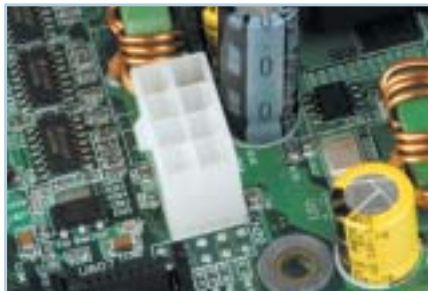
Konektory napájení ATX EPS serverového typu, umístěné na základní desce. Základní napájení je řešeno 24kontaktním konektorem.
