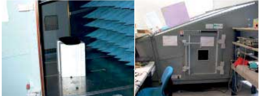
Tak jako existují komory, které jsou prosty akustických vzruchů, existují i ty, které jsou prosty vzruchů rádiových. Tahle slouží v Logitechu k testu bezdrátové komunikace.
