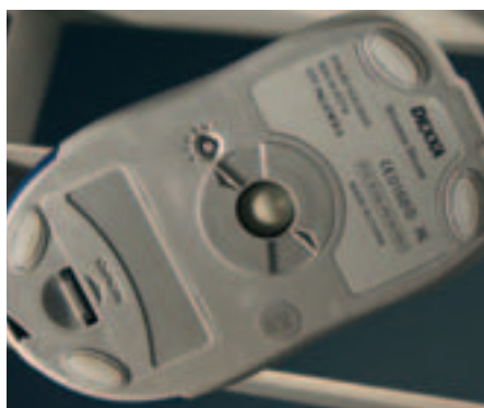
Klasická myš používá ke snímání pohybu kovovou pogumovanou kuličku, která otáčí dva válečky umístěné horizontálně a vertikálně. Problém je, že se válečky často špiní.
