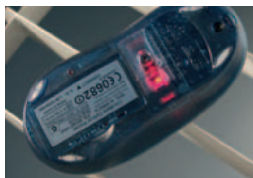
Optické myši využívají ke zjišťování pohybu optický snímač, kterému na cestu svítí dioda.
