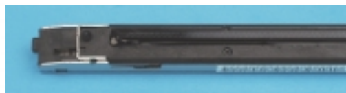
Tiskárna OKI používá místo laseru pole miniaturních diod umístěných ve dvou řadách.
