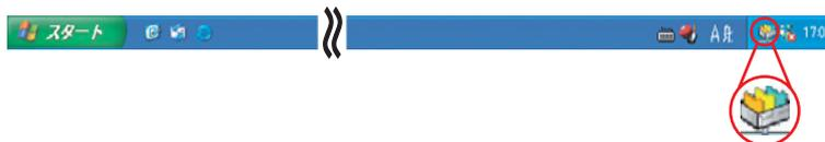
タスクバーの PowerCopy2 サーバアイコンをクリックすると、PowerCopy2 サーバダイアログが表示されます。
