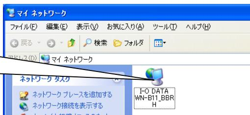
下の画面が表示されていたら、正常にWN-B11/BBRHが認識されています。
