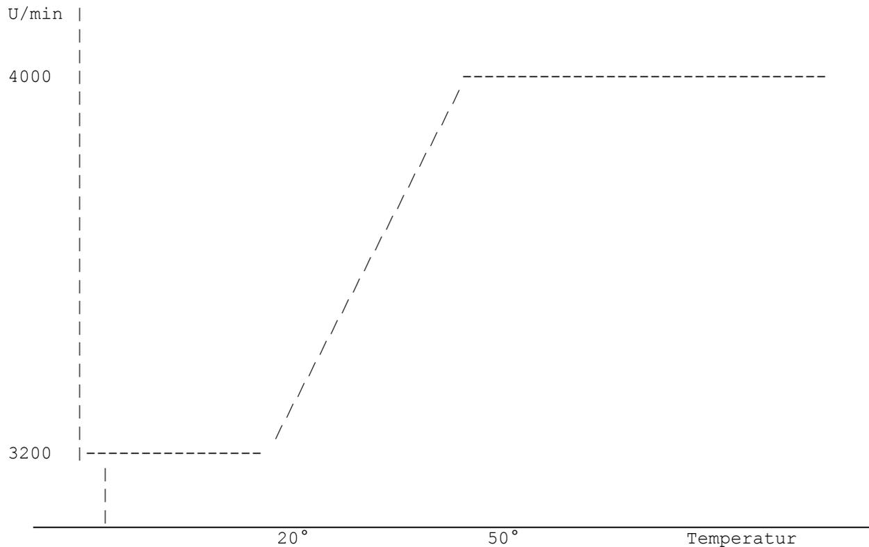
Dies ist der Verlauf der Lüfterdrehzahl in Abhängigkeit von der Temperatur bei den eingestellten Werten (bezogen auf 4000 U/min Nennendrehzahl)
