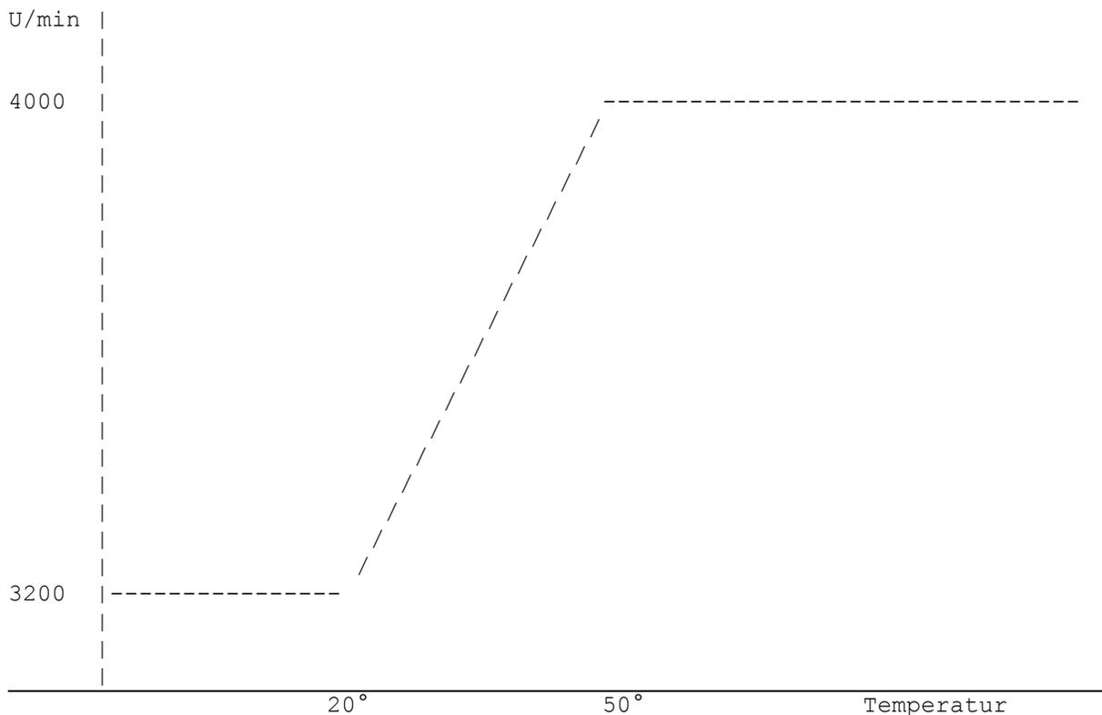
Dies ist der Verlauf der Lüfterdrehzahl in Abhängigkeit von der Temperatur bei den eingestellten Werten (bezogen auf 4000 U/min Nennndrehzahl)
