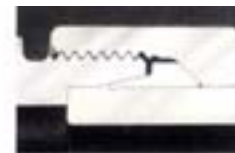
Pierścień kształtowy - nie ma odkształceń przy nadmiernym dokręcaniu nakrętki
