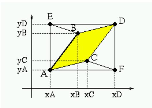
Area del parallelogramma  $ABDC = \text{area del rettangolo } AEDF - \text{aree dei triangoli } EAB, EBD, AFC, CFD$  (tutte aree con segno).
