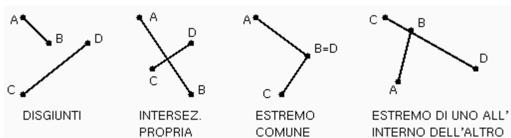
Nel caso 1, si ha che  $\alpha_A$  e  $\alpha_B$  definiscono entrambi una svolta non nulla e dello stesso segno rispetto a  $CD$ , oppure viceversa  $\alpha_C$  e  $\alpha_D$  definiscono una svolta non nulla e dello stesso segno rispetto a  $AB$ .
