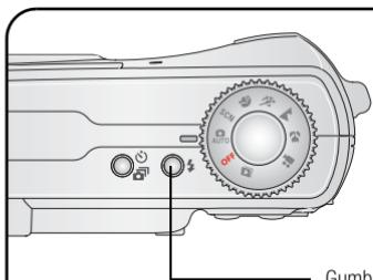
Za kretanje kroz načine rada bljeskalice (vidi tablicu načina rada bljeskalice) više puta pritisnite gumb bljeskalice.
