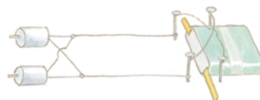
Los cuatro clavos y la pila de petaca forman una llave de cruce que controla el sentido de giro de los motores.
