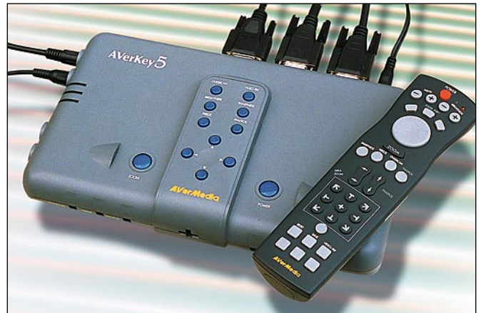
AverKey 5 on VGA-TV-muunnin, joka kätevä kokonsa vuoksi sopii erityisesti salkkumikron kanssa käytettäväksi.
