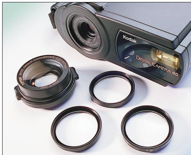
Kodakin kameraan on lisävarusteena saatavissa laajakulma- ja lähilinssejä. Lisälinsien käyttöä hankaloittaa se, että läpikatseleva etsin ei varsinkaan lähikuvia otettaessa anna kovin tarkkaa käsitystä kuvan rajauksesta.
