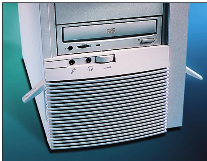
HP:n minitornikotelo ei edestä päin ole sen kummallisemman näköinen kuin tavalliset 486-mikrot. HP kiinnittää kuitenkin huomiota myös PC:n mekaaniseen rakenteeseen. Koteloa voi avata ilman työkaluja etureunan lukkosaloilla. Miellyttävä yksityiskohta on tuoda ääniliittimet etupaneeliin.
