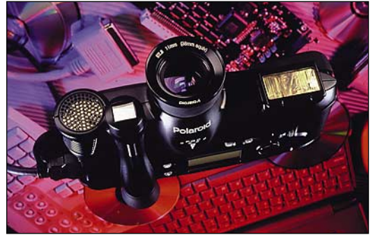
Polaroid PCD-2000 -digitaalikameran CCD-kennossa on miljoona kuva-alkiota.
