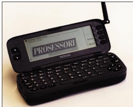
Kommunikaattorin ohjelmia käytetään ruudun sivuilla olevilla näppäimillä. Nokia odottaa, että WWW-sivujen kautta palveluja tarjotaan kommunikaattorin pienen ruudun.
