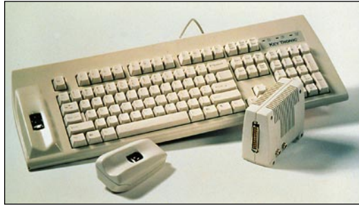
Key Tronic esitteli joukon erkoisnäppäimistöjä. Kuvan näppäimistö tunnistaa käyttäjänsä sormenjäljen.
