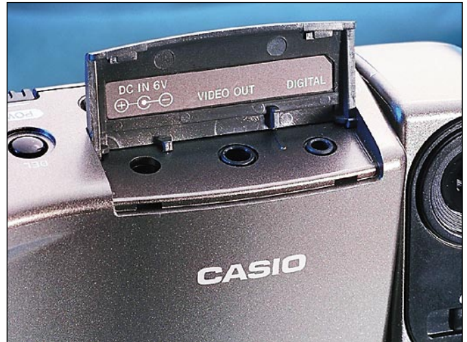
Casion kameran saa liitettyä tietokoneen lisäksi myös tavalliseen videoliitännällä varustettuun televisioon. Tietokoneliitäntä on kaksisuuntainen, joten kameralla voi näyttää myös tietokoneella käsitellyjä kuvia.
