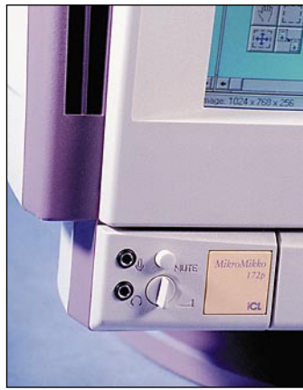
ICL:n tyylikkäässä näytössä on kuuloke- ja mikrofoni-liitännät tuotu hyvin käyttäjän ulottuville.
