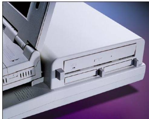
Compaqin laajennusyksikössä on kaksi samanlaista massa-muistipaikkaa kuin itse mikroissa. CD-aseman ja levykeaseman paikkaa voidaan näin vaihtaa vapaasti.
