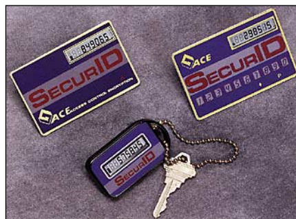
Security Dynamics tarjoaa omaa ratkaisuaan verkon käyttäjien autentisointiin. Käyttäjän tunnistamiseen käytetään henkilökohtaista tunnuslukua ja SecurID:n antamaa kertakäyttöistä tunnusta.
