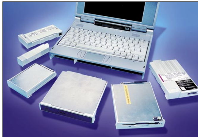
ICL:n mukana toimitetaan vakiona melkoinen palapeli. Huomattavaa on että CD-asemaa ja vakioakkuja ei voi käyttää samanaikaisesti. Virtalähde toimii joko mikron sisäisenä osana tai johdon päässä irrallaan pöydällä mikron vieressä.
