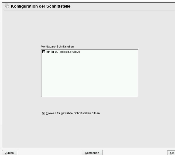
Abbildung 23.11 DHCP-Server: Netzwerkschnittstelle und Firewall
