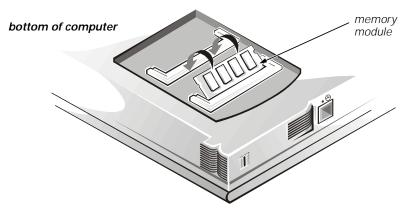
Figure 3-9. Installing a Memory Module
