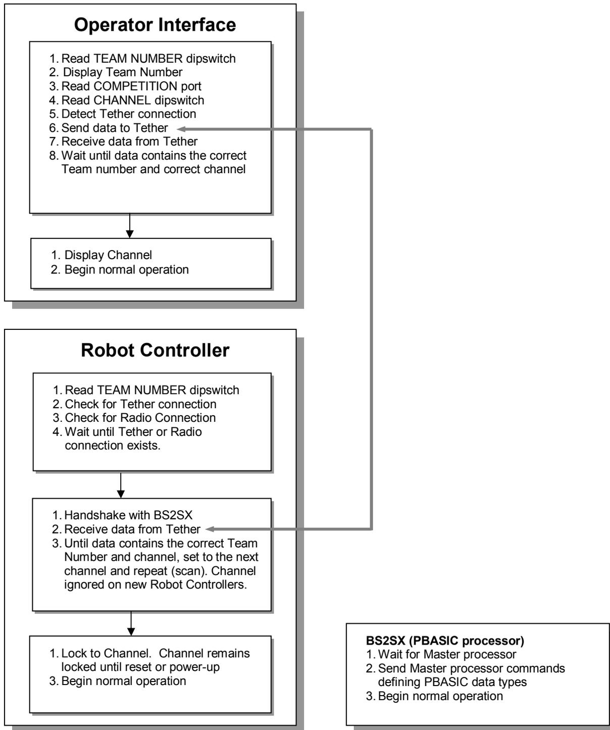
**FIGURE 1.3: CONTROL SYSTEM TETHER STARTUP DIAGRAM**
