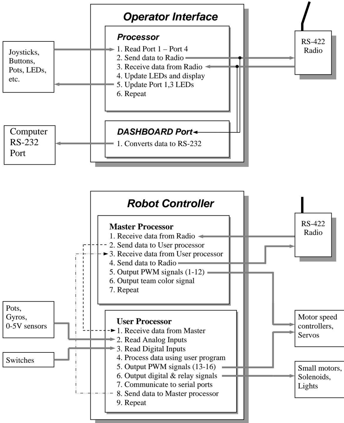
**FIGURE 1.1: CONTROL SYSTEM OPERATION DIAGRAM**
