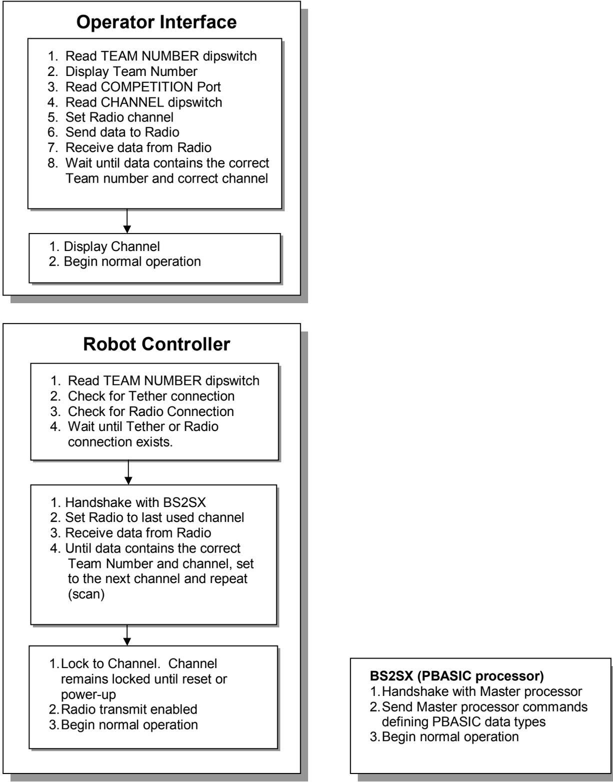
**FIGURE 1.2: CONTROL SYSTEM RADIO STARTUP DIAGRAM**
