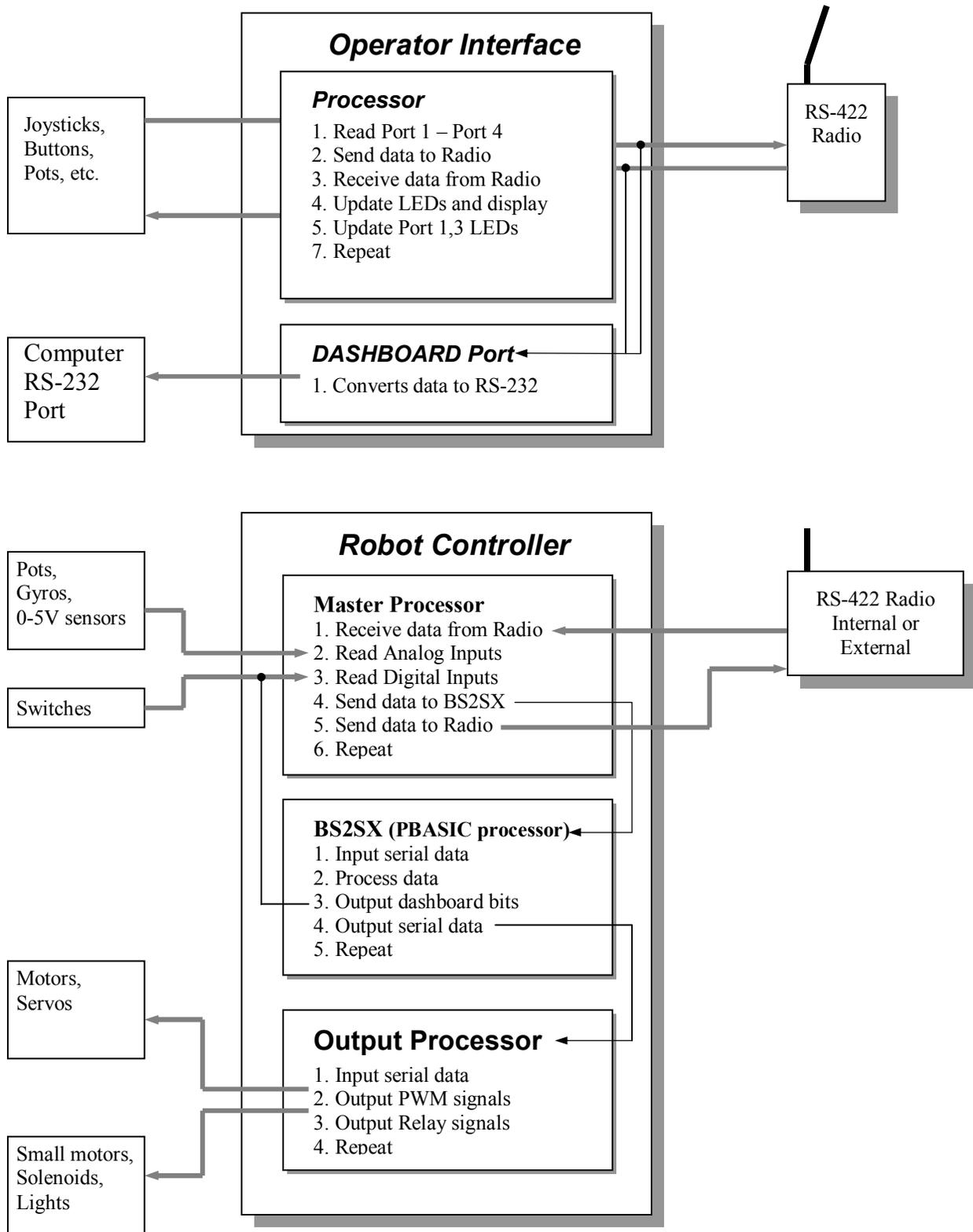
FIGURE 1.1: CONTROL SYSTEM OPERATION DIAGRAM
