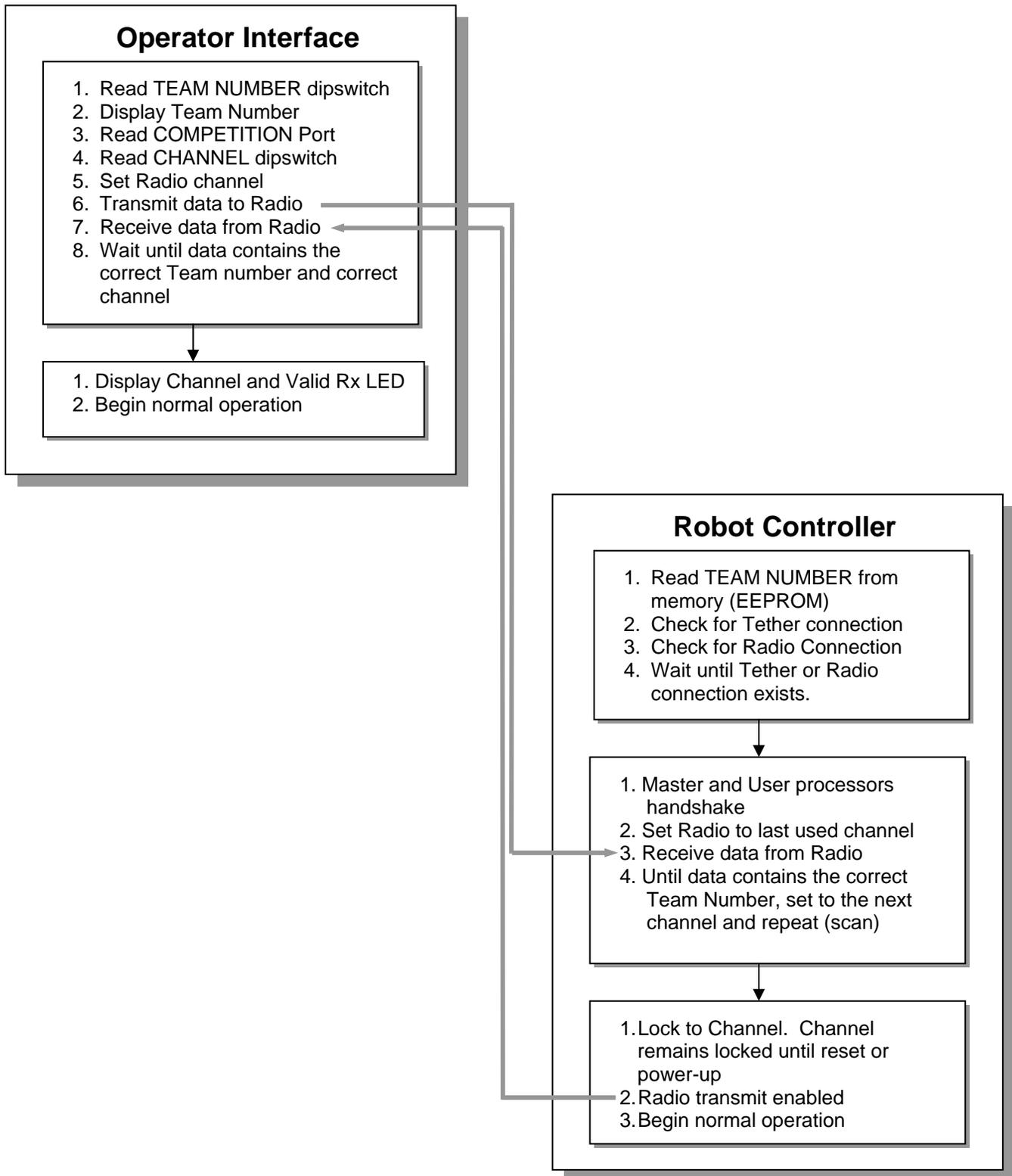
**FIGURE 1.2: CONTROL SYSTEM RADIO STARTUP DIAGRAM**
