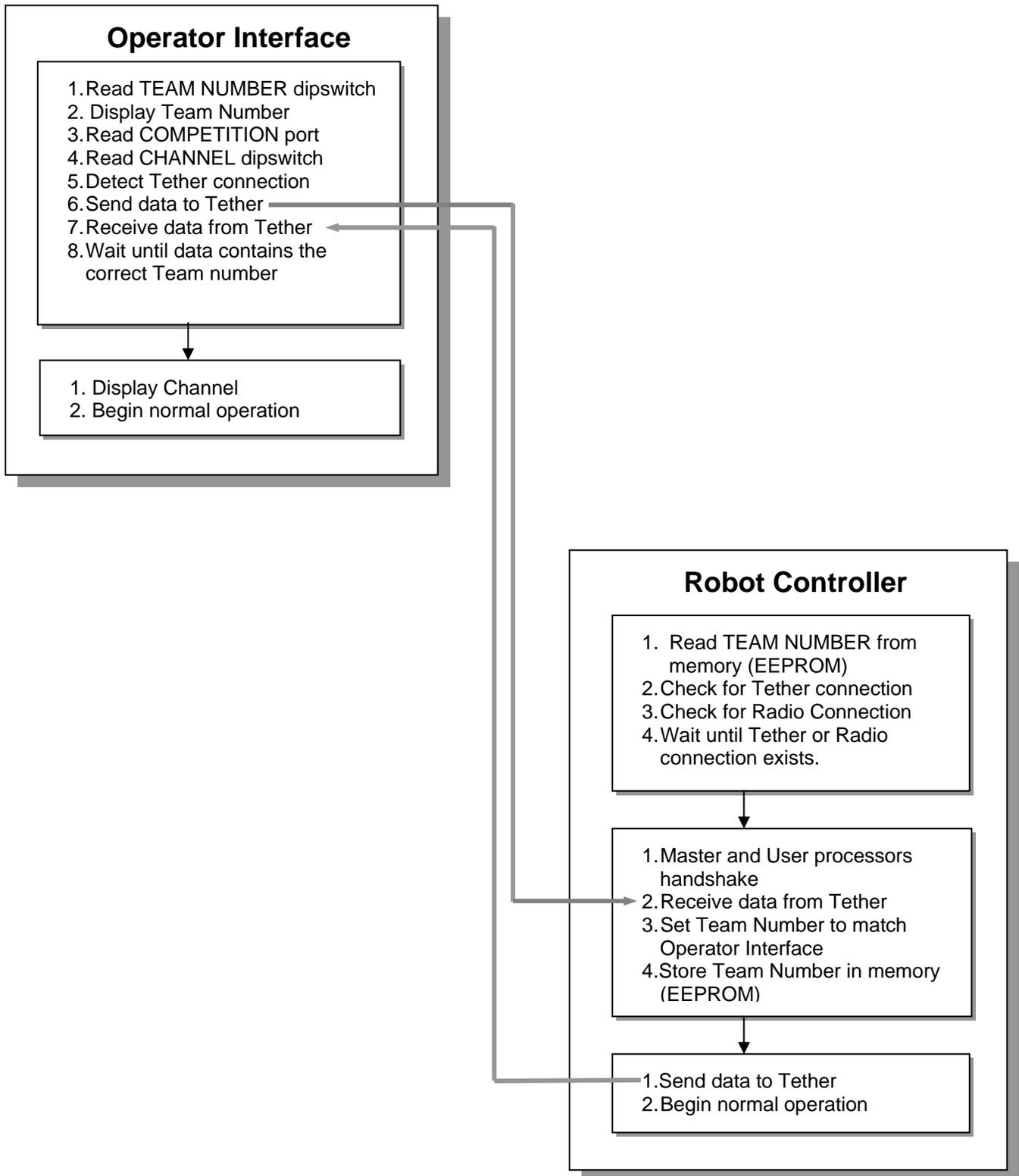
**FIGURE 1.3: CONTROL SYSTEM TETHER STARTUP DIAGRAM**
