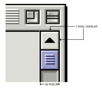
FIG 6 - CORRECT OVERLAP OF SCROLL BAR ON WI
