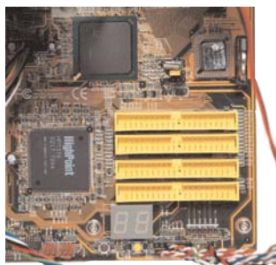
FlashNet ha dejado libres las cuatro ranuras PCI para futuras ampliaciones.
