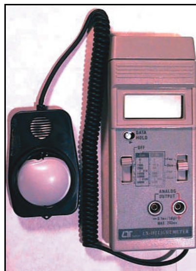
«Fotografía 2». La curva de calibración y el ajuste de las medidas se ha realizado con la ayuda de un luxómetro LX-102.
