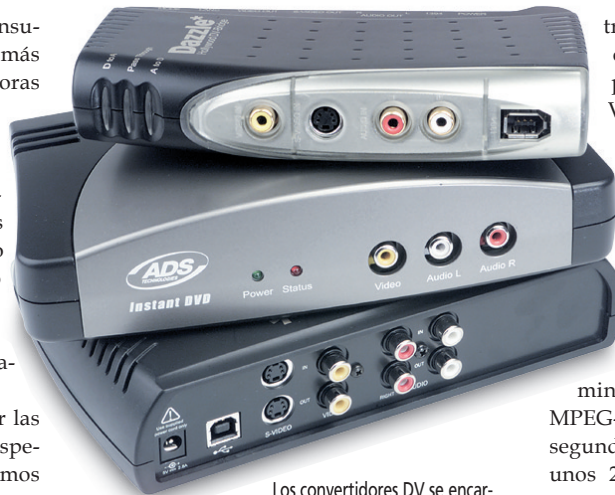
Los convertidores DV se encargan de transformar el vídeo analógico de forma interna, reduciendo el uso de la CPU.
