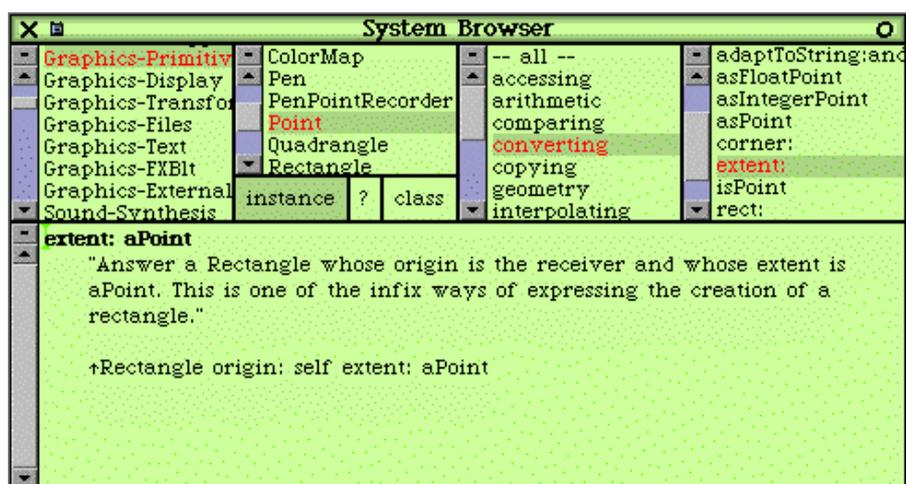
**Figure 1** Un navigateur de classe montrant la méthode extent : définie dans le protocole de méthode converting de la classe Point contenue dans la
